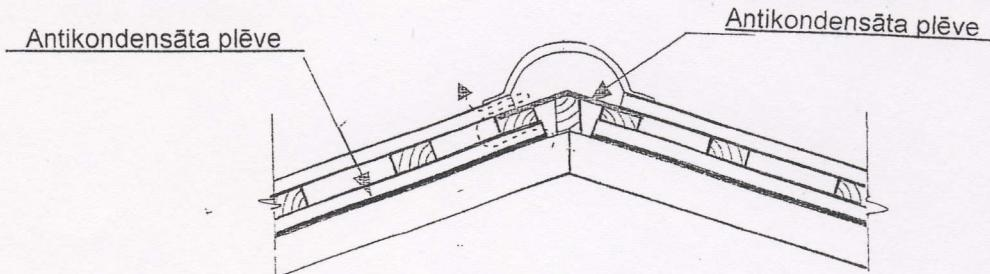
Antikondensāta plēvei (RA6U vai RA6U B) ieklāj horizontāli uz spārēm, sākot no dzegas. Plēvei jābūt vismaz 200 mm pāri sienas līnijai jumta apakšējā un sānu malās. Plēvi pie spērēm stiprina ar skavām. Katra augšējā plēves kārta tiek pārlaista pāri apakšējai virsmai par vismaz 150 mm.
